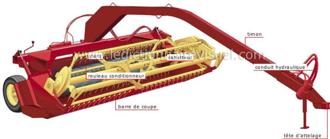
Pour l'herbe, utilisation d'une faucheuse conditionneuse à rouleau pour éviter la perte des feuilles. Faucher préalablement en laissant l'herbe sur le sol pendant 24 à 36 heures pour éviter la production de jus (perte des sucs). Utiliser l'ensileuse à maïs rééquipée d'un pick-up pour ramasser les andains d'herbe. Il faudrait que l'humidité d'ensilage passe de 45 à 30 % (il manque des points de repère pour connaître ce moment opportun).
